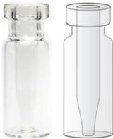
Mikrovial mit einem eingeschmolzenen Insert, welches einen gemeinsamen Boden mit dem Aussenvial bildet. Von der Funktionalität her ist es dasselbe, wie wenn ein loses Insert benutzt wird, nur dass das Insert des  $\mu$ -Vials fest mit dem Aussenvial verbunden ist, sicher in die Öffnung der Flasche passt und aufrecht steht. Das Gesamtvolumen beträgt 350  $\mu$ l und das Fussvolumen 10  $\mu$ l.
