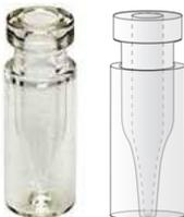
Das Insert ist in den Körper eines 2 ml Vials integriert, das Insert wird direkt verschlossen. Dadurch entsteht ein direkt verschlossener Probenraum von 250  $\mu$ l, sodass sich das  $iV2\mu$ -Vial für den Einsatz mit flüchtigen Proben eignet, da kein Probendampf in den Hohlraum zwischen Vial und Insert entweichen kann.
