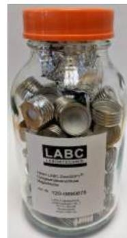
**ZeroSept® SILP** sind hochreine Silikon-Verschlüsse. Unser Silikon ist eine neue und besonders saubere Mischung und sorgt für störpeakarme Messungen. Die Silikonsepten sind mit einer PTFE Barrierefolie kaschiert. Mit 38° Shore ist das Septum zudem sehr weich.
