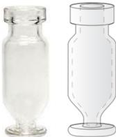
Das grösste Volumen kann das Väschen oder  $V\mu$ -Vial aufnehmen. Es fasst 1.2 ml bis zur Schulter und 15  $\mu$ l im Fussbereich. Da das Väschen die preislich günstigste Lösung ist, empfehlen wir diese Version für alle Arbeiten bis zu einem Restvolumen von 15  $\mu$ l.
