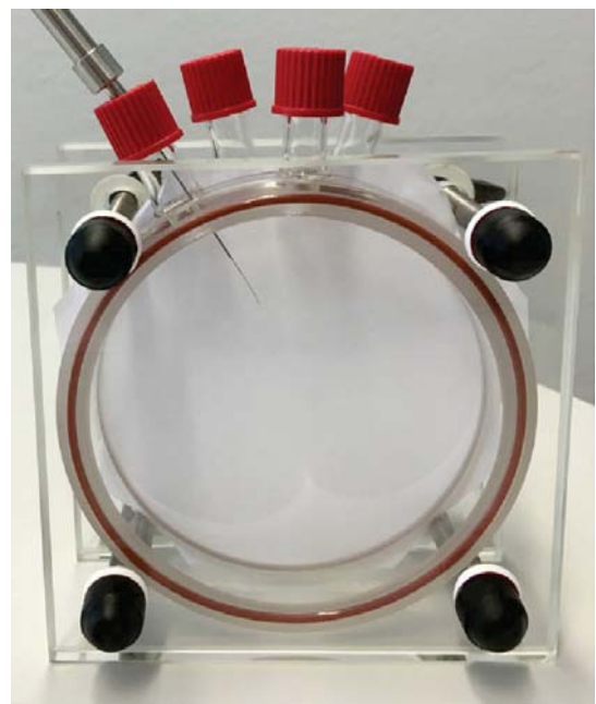
▶ SPME Fiber Holder - Festphase sichtbar
