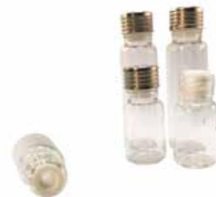
**Bilimex®LD PTFE165/Glas** bestehen aus ND18 Feingewindflaschen mit gerundetem Boden und Glas der 1. hydrolytische Klasse, sowie einem PTFE-Einsatz mit einem Kapillarvolumen von 165 µl. Bilimex®LD ist für den Einsatz in Zentrifugen bis 1800g geeignet. Für jede Charge wird ein Werkszeugnis nach EN 10204 bereitgestellt
