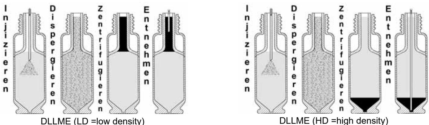
Bei der links skizzierten DLLME wird eine wässrige Probe mit einem mit Wasser nicht mischbaren Extraktionsmittel und einem mit Wasser mischbaren Dispergiermittel vermischt. Das Extraktionsmittel ist LD mit niedriger Dichte.
