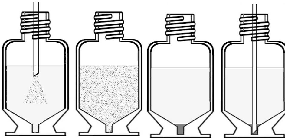
Bei der skizzierten DLLME wird eine wässrige Probe mit einem mit Wasser nicht mischbaren Extraktionsmittel und einem mit Wasser mischbaren Dispersionsmittel versetzt.
