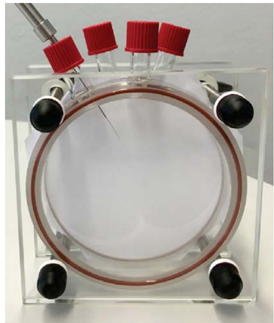
▶ SPME Fiber Holder - Festphase sichtbar
