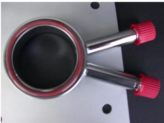
3. Als Dichtelemente werden chemikalienbeständige, flexible FEP-O-Ringe verwendet. Die Einfüllstutzen haben einen für die Befüllung des Mittelringes praktikablen Innendurchmesser, der mit einer laborüblichen temperaturbeständigen GL14-Schraubkappe verschlossen werden kann.
