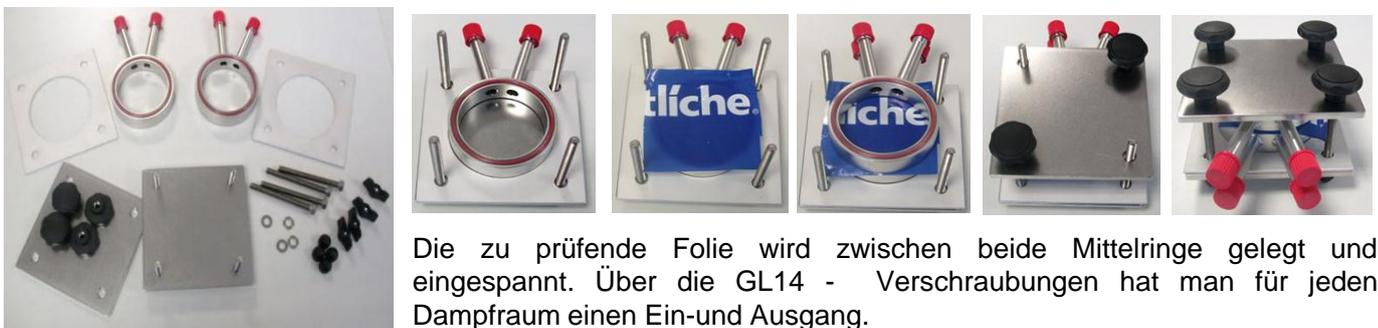
Die zu prüfende Folie wird zwischen beide Mittelringe gelegt und eingespannt. Über die GL14 - Verschraubungen hat man für jeden Dampfraum einen Ein- und Ausgang.
