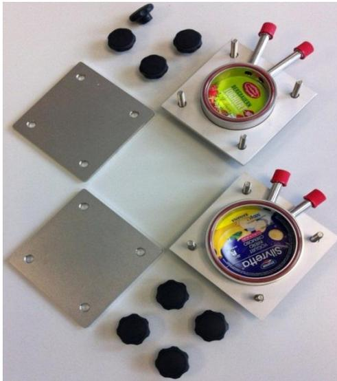
Im oberen Bild sind die Migrationszellen System Siegwark (Sieg-Mi-Flex) mit den Mittelringen DN90 und DN70 abgebildet. Sie passen optimal zu den gängigen Joghurtdeckeldurchmessern von 95,5mm und 75,5mm.
