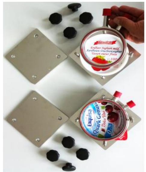
Im unteren Bild sind die Migrationszellen System Siegwark (Sieg-Mi-Flex) mit den Mittelringen DN120 und DN110 abgebildet. Sie passen optimal zu den Joghurtdeckeln aus Aluminium mit einem Durchmesser von 125mm und den Joghurt-Stülpdeckeln mit einem Durchmesser von 115mm.
