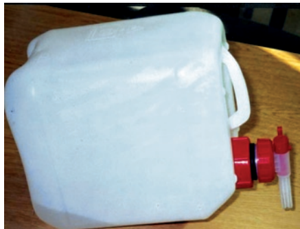
Abb. 1: Gute Idee: Gängige Lösemittel werden in einen 5-Liter-PE-Kanister aus Kunststoff mit sehr praktischen Eigenschaften abgefüllt.
