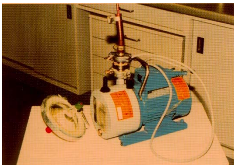
Abb. 2 links: Glasgerät zur Untersuchung der Rück- und Vorderseite von Verpackungsmaterial, Vakuumpumpe
