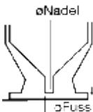
Die großen Vasenvials können ohne Support stehen. Ideal für die automatische Probenvorbereitung. Das VMax-Vial hat einen zylindrischen Fuss. Der "kegliche Fuß" ist bei der Entnahme in einem Probengeber technisch überlegen.
