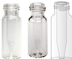
Mikrovial mit einem eingeschmolzenen Insert, welches einen gemeinsamen Boden mit dem Aussenvial bildet. Von der Funktionalität her ist es dasselbe, wie wenn ein loses Insert benutzt wird, nur dass das Insert des  $\mu$ -Vials fest mit dem Aussenvial verbunden ist, sicher in die Öffnung der Flasche passt und aufrecht steht. Das Gesamtvolumen beträgt 350  $\mu$ l und das Fussvolumen 10  $\mu$ l.
