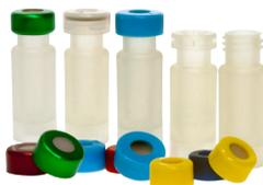
Vial aus Weichmacherfreiem Polypropylen. Die innere Form des Vials mit einer optimierten Restmengenentleerung ist ideal für die Probenahme von kleinsten Volumina und erlaubt das universelle Arbeiten im Bereich von 100 bis 700  $\mu$ l Probenvolumen. Auf Grund des hohen Bodens, kann mit sehr kleinen Volumen gearbeitet werden und je nach Nadel-Geometrie kann das effektive nicht injizierbare Volumen extrem klein sein.
