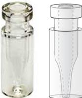
Das Insert ist in den Körper eines 2 ml Vials integriert, das Insert wird direkt verschlossen. Dadurch entsteht ein direkt verschlossener Probenraum von 250  $\mu$ l, sodass sich das iV2 $\mu$ -Vial für den Einsatz mit flüchtigen Proben eignet, da kein Probendampf in den Hohlraum zwischen Vial und Insert entweichen kann.
