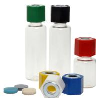
Headspace-Chromatographie verlangt nach druckdicht verschlossenen Gefäßen. Dies erfordert einen hohen Kraftaufwand und bei grösseren Serien treten schnell Ermüdungserscheinungen beim Bedienungspersonal auf. Das von uns entwickelte schraubbare Headspace-Vial benötigt nur noch ein Drehmoment  $< 1 \text{ Nm}$  für den druckdichten Verschluss. Bisherige Lösungen benötigten ein Drehmoment  $> 8 \text{ Nm}$ .
