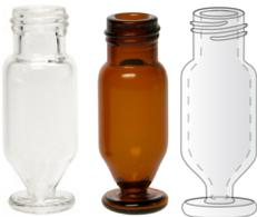
Das grösste Volumen kann das Väschen oder V $\mu$ -Vial aufnehmen. Es fasst 1,2 ml bis zur Schulter und 15  $\mu$ l im Fussbereich. Da das Väschen die preislich günstigste Lösung ist, empfehlen wir diese Version für alle Arbeiten bis zu einem Restvolumen von 15  $\mu$ l.
