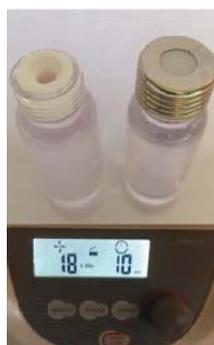
bilimex®LD PTFE165/Glas ist kostengünstig zu produzieren und lässt ebenfalls eine DLLME mit einem Lösemittel leichter als Wasser zu. Es eignet sich insbesondere für Routineanwendungen mit sehr hohem Durchsatz, bei dem eine Reinigung der bilimex®-Extraktoren nicht gewünscht ist.
