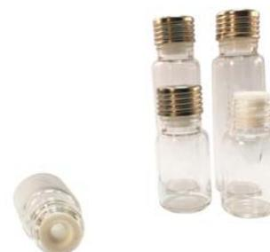
**Bilimex®LD PTFE165/Glas** bestehen aus ND18 Feingewindflaschen mit gerundetem Boden und Glas der 1. hydrolytische Klasse, sowie einem PTFE-Einsatz mit einem Kapillarvolumen von 165 µl. Bilimex®LD ist für den Einsatz in Zentrifugen bis 1800g geeignet. Für jede Charge wird ein Werkszeugnis nach EN 10204 bereitgestellt
