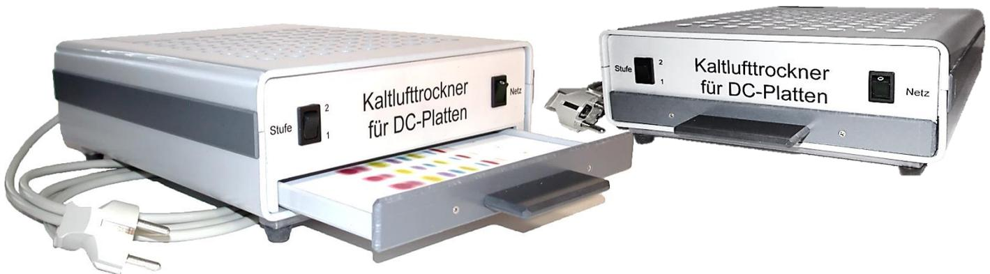
Durch herausziehen der Geräteschublade kann eine DC-Platte (max. 20 x 20 cm) eingelegt werden. Die Schublade wird wieder geschlossen und der Netzstecker eingesteckt. Das Gerät wird über den grünen Wippenschalter in Betrieb genommen (leuchtet grün). Über den schwarzen Stufenschalter kann die Stärke des Luftstroms gewählt werden: Stufe 1: zwei Lüfter / Stufe 2: vier Lüfter. Nach der Inbetriebnahme wird die Raumluft von oben über einen Vliesfilter angesaugt und die DC-Platte getrocknet.
