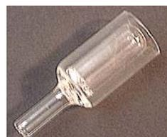
Absorptionsrohr mit rundum 1 mm Bohrungen, Länge: 70 mm
