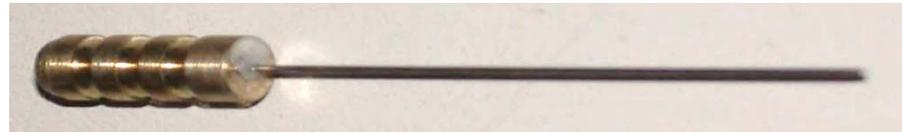
Headspacenadel mit Olive zum evakuieren von Septen verschlossener Probenflaschen etc.
