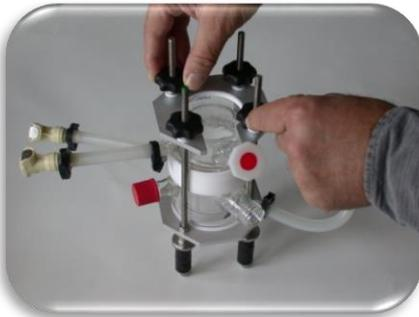
Alle 4 Schnellverschraubungen lösen.
