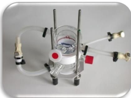
Oberes Glasgefäß einsetzen und die Schlauchverbindung via Schnellkupplung schließen.
