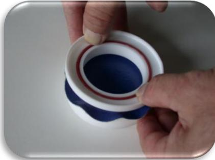
Ober- und Unterteil der Probenhalterung zusammensetzen.
