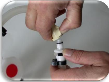
Schlauchverbindungen via Schnellkupplung trennen.
