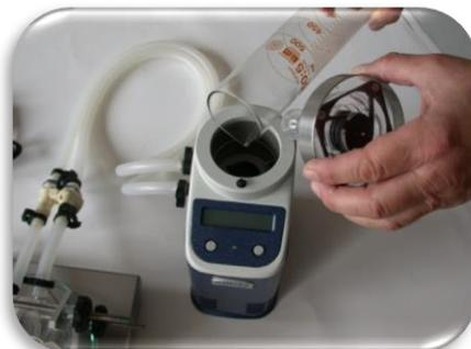
Thermostat öffnen und portionsweise mit Wasser befüllen, bis die Luft aus dem Schlauchsystem entfernt ist.
