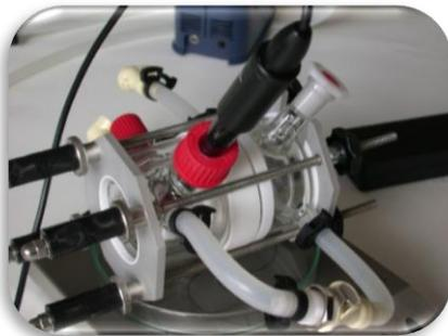
Die Leitfähigkeits- oder pH-Sonde einsetzen.
