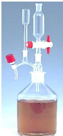
Mikroextraktor dient für die Isolierung lipophiler Stoffe aus Wasser durch Flüssigphasen-Extraktion nach DIN 38407-8: 1995-10. Vorteilhafter Einsatz bei der Extraktion mit aliphatischen und cyclischen Kohlenwasserstoffen von belasteten Wasserproben und auftretender Emulsionsbildung.
