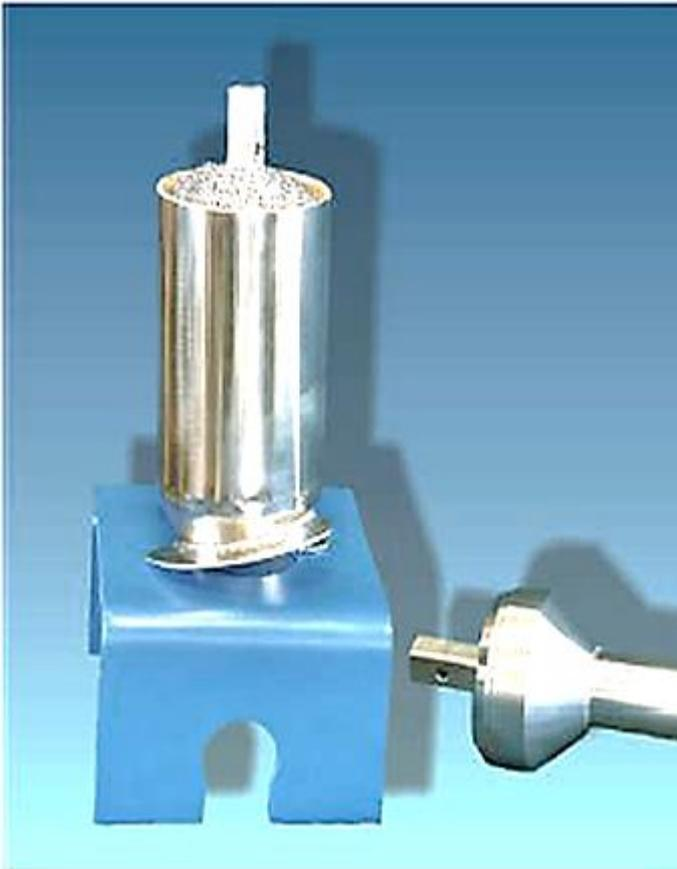
Nach Entnahme der Probe kann die Spitze des Silo-Bulky's in den mitgelieferten Ständer gestellt werden. Die Sammelkammer wird mit einem einfachen Handgriff von der Stange getrennt und in ein Probensammelgefäß entleert.
