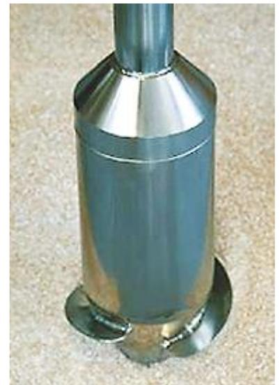
Der neu entwickelte **Silo-Bulky** erlaubt eine schnelle Probenahme von Schüttgütern – und zwar aus dem Produkt. Er wird einfach in das Schüttgut geschraubt. Auch in schweren Schüttgütern lassen sich so Tiefen bis zu zwei Meter erreichen. Die 3D-Grabschaufeln lockern das Schüttgut bereits beim Eindringen auf.
