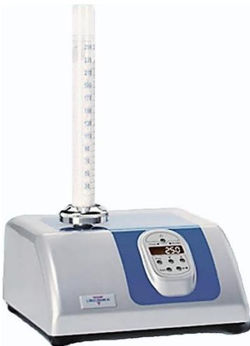
Stampfvolumeter STAV II mit Messzylinder zur Ermittlung des Stampfvolumens und der Stampfdichte von pulverigen, faserigen und granulatförmigen Produkten nach DIN ISO 787 Teil 11, ISO 3953 und ASTM B 527-93.
