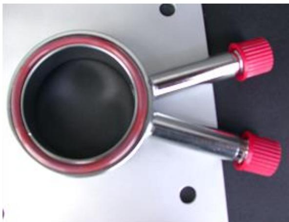
3. Como elementos de obturación se usa anillos “FEP-O” resistentes a químicos. Las bocas de llenado tienen unos diámetros internos adecuados para llenar el anillo central que se puede cerrar con un cierre de rosca “GL14” (estándar en laboratorios) que se destaca a través de su resistencia térmica.
