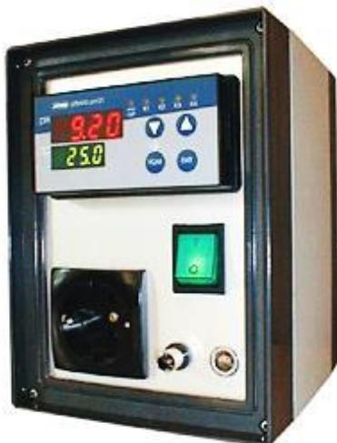
Ein pH-Regler der Spitzenklasse mit Mikroprozessor, anschlussfertig, mit Steckdose 3A/AC, –hier angeschlossene Pumpen oder Magnetventile werden in Abhängigkeit vom pH-Wert an- oder ausgestellt–, Stativbefestigung, ständige digitale Ist- und Sollwertanzeige, BNC-Stecker und 4-polige Lemobuchse für Pt100
