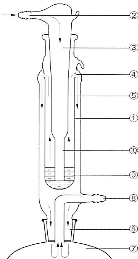
Die LABC-Gaswaschflasche ist eine Kombination aus zwei teilen. Im Inneren besteht sie im Prinzip aus einer üblichen Waschflasche ①.
