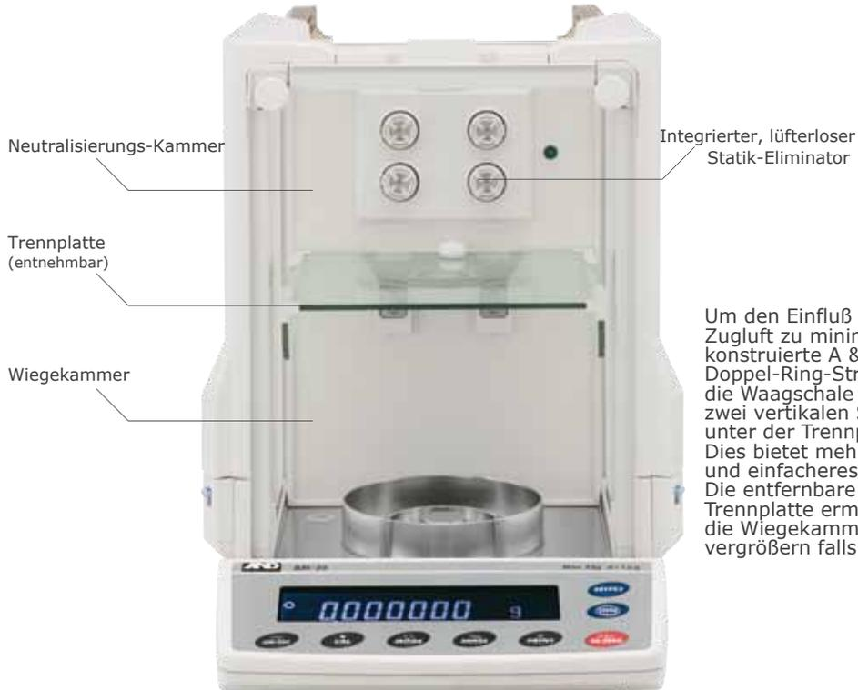
Um den Einfluß von Zugluft zu minimieren, konstruierte A & D eine Doppel-Ring-Struktur um die Waagschale herum und zwei vertikalen Schilde unter der Trennplatte. Dies bietet mehr Raum und einfacheres Handling. Die entfernbare Trennplatte ermöglicht es die Wiegekammer zu vergrößern falls nötig.
