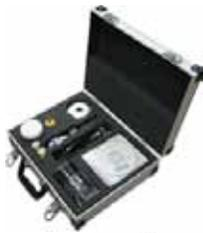
BM-014: Pipetten-Test-Kit (für BM-20/22): Verdunstungsfalle, spezielle Probengefäße, Auswertesoftware nach ISO8655 und die dazugehörige Ausrüstung. Alles praktisch in einem Transportkoffer.
