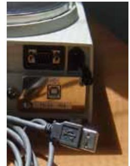
Beispiel: Quick USB Schnittstelle montiert in einer FX-i Präzisionswaage
