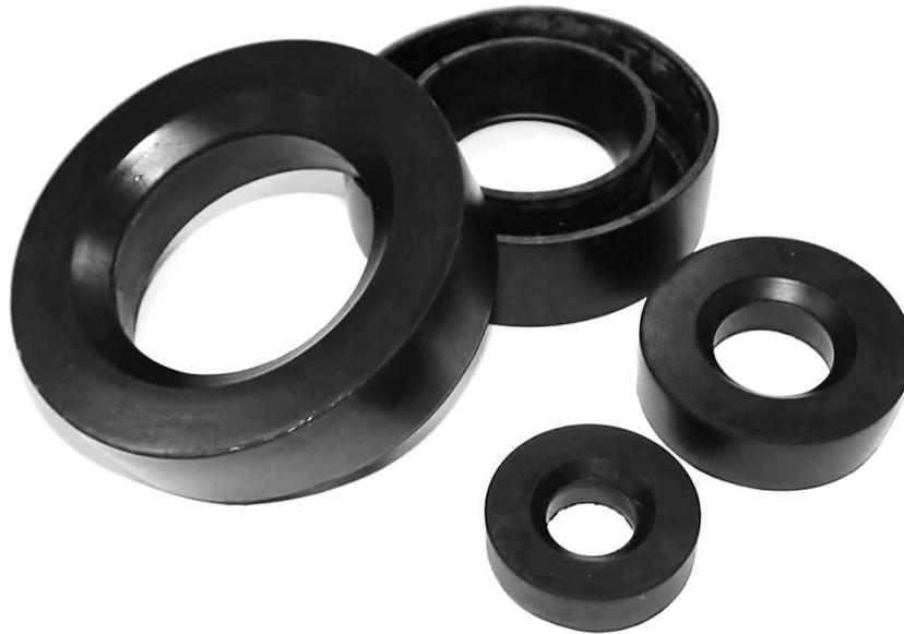
Die Schutzmanschette für Glassaugflaschen gibt durch die speziell gestaltete Form den aufgesetzten Trichtern, Filtern und Nutschen eine Zentrierung und stabilen Stand. Gleichzeitig erfolgt die saubere Abdichtung zwischen Glasflansch und dem aufgesetzten Gefäß. Durch Anlegen des Vakuums wird die Dichtkraft laufend unterstützt. Der Werkstoff der Schutzmanschette ist EPDM, der sich in vielen Einsätzen im Labor bewährt hat.
