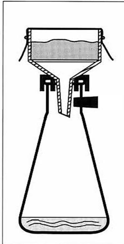
Durch überstreifen eines Gummiringes wird sie fixiert und anschließend glattgezogen, so dass an den Kanten keine Falten entstehen.
