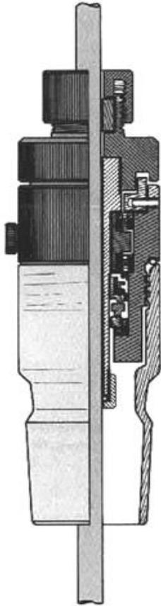
LABC-Gleitring-Rührverschluss mit Gleitringdichtungen aus Keramik und gekapselten Kugellagern aus Edelstahl gewährleistet ein problemloses und sicheres Arbeiten bei hohen Ansprüchen.
