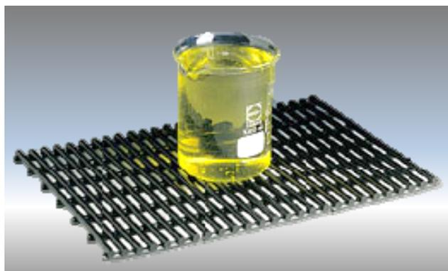
Die **LABC-Spülbeckenmatte** erlaubt ein problemloses Arbeiten bei der Reinigung von Laborgeräten. Sie verhindert Glasbruch und das Zurückspritzen von fließendem Wasser durch die runden Kunststoffprofile. Die glatte Oberfläche der Profile verhindert das Festsetzen von Schmutzpartikeln. Das Eigengewicht der Matte ist so bemessen, dass sie auch bei Unterspülung fest aufliegt. *Zusätzlicher Vorteil:* Magnetstäbchen in Normalgröße gelangen nur unter erschwerten Bedingungen in den Abfluss.
