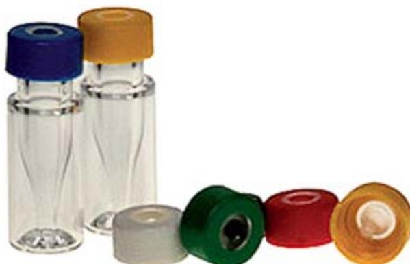
Durch den verbreiteten Einsatz von MS-Detektoren mit sinkenden Nachweisgrenzen werden Störpeaks immer mehr ein Problem in der täglichen Analytik. Diese Systempeaks werden aus den elastomeren Septummaterialien beim Durchstechen der Mikroliterspritzennadel in kleinsten Mengen abgeschabt, gelangen so in die Probe, und Inhaltsstoffe des Elastomeres lösen sich im Lösungsmittel. Dies kann sich besonders im GC-Bereich störend bemerkbar machen.
