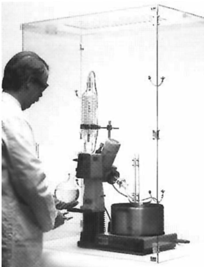
Die LABC-Sicherheitsbox besteht aus drei leicht transportablen Einzelteilen, die mit Magnetschnäpper verbunden und mit zusätzlichen Ketten gesichert werden. Alle Teile sind aus Polycarbonat gefertigt und ermöglichen freie Sicht von allen Seiten. Die verriegelbaren Eingriffsöffnungen ermöglichen sichere Bedienungen einer Apparatur während des Betriebes. Die Sicherheitsbox ist standfest, schnell auf- und abgebaut, benötigt nur geringe Lagerfläche.
