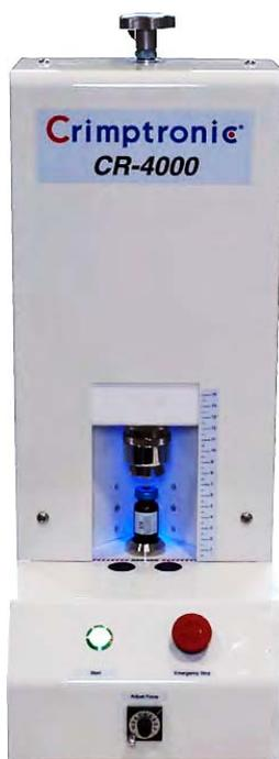
Dieses Modell ist ideal für Flaschenserien sowie einen gelegentlichen Gebrauch. Die Flaschen werden individuell mit der hochwertigen mikroprozessorgesteuerten Verbördelungstechnologie, unter reproduzierbaren und sicheren Bedingungen, verschlossen.
