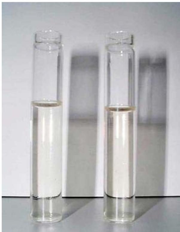
Farbbewertungen in der chemischen Industrie an Ölen, Fetten, Harzen, Tensiden, Glykolen oder ionische Lösemittel werden visuell oder mit den Farbmessgeräten von Hach-Lange (Lico® 100, 300, 400) durchgeführt. Zur Farbzahlbestimmung steht z.B. die preisgünstige Glas-Einweg-Küvette (LYY 621) zur Verfügung.
