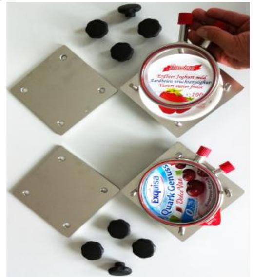
En la ilustración inferior se muestran las células migratorias del sistema Siegwerk (Sieg-Mi-Flex) con los anillos centrales DN120 y DN110. Éstas son totalmente compatibles con las tapas de yogur de aluminio con un diámetro de 125 mm y las tapas de yogur tipo caperuza, con un diámetro de 115 mm.
