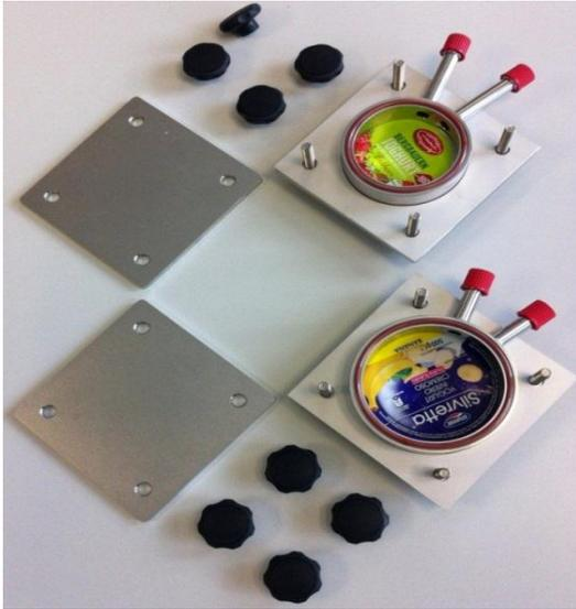
En la ilustración superior se muestran las células migratorias del sistema Siegwerk (Sieg-Mi-Flex) con los anillos centrales DN90 y DN70. Son totalmente compatibles con el estándar de diámetros de tapas de yogur de 95,5 mm y 75,5 mm.
