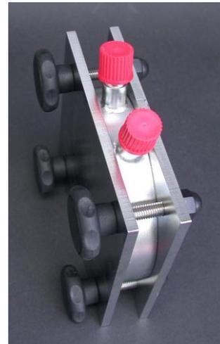
2. La célula de migración hecha de acero fino se puede cerrar y abrir muy fácilmente gracias a su rueda de mano hecha de plástico que tiene una forma ergonómica. Debido a su forma compacta y económica en cuanto al espacio que requiere y en caso de temperación en un armario de secado, se puede almanecer la célula de migración de manera horizontal y vertical.
