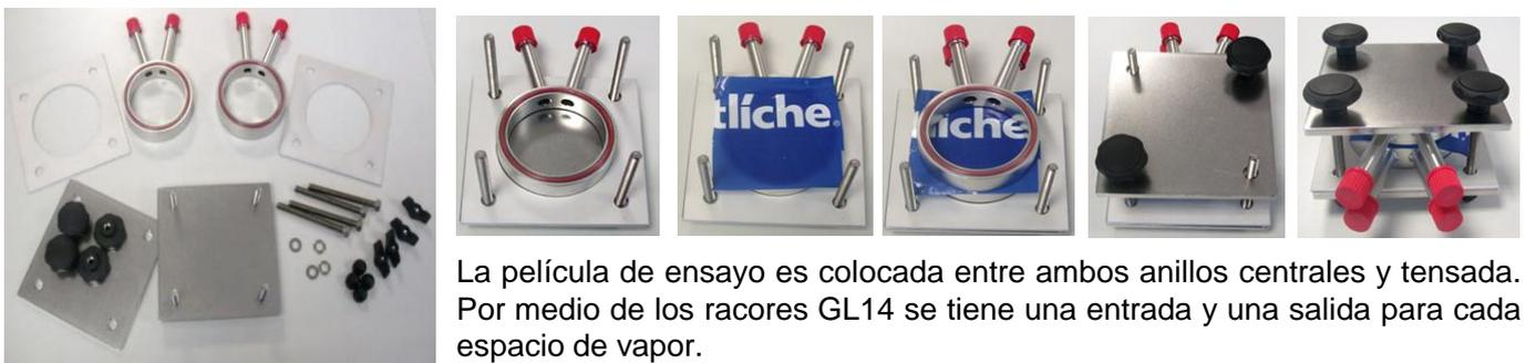
La película de ensayo es colocada entre ambos anillos centrales y tensada. Por medio de los racores GL14 se tiene una entrada y una salida para cada espacio de vapor.
