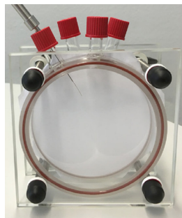
SPME Fiber Holder - Festphase sichtbar
